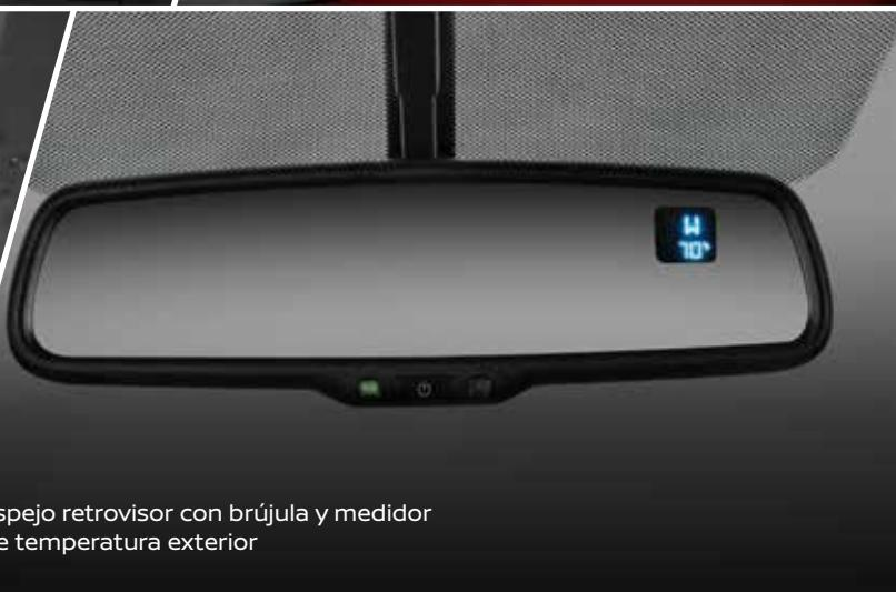
Espejo retrovisor con brújula y medidor de temperatura exterior
