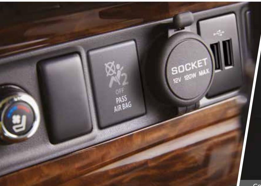
Consola delantera con socket de 12 V y 2 entradas USB
