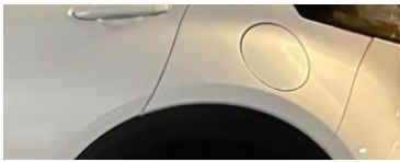
Tapa de llenado de combustible
