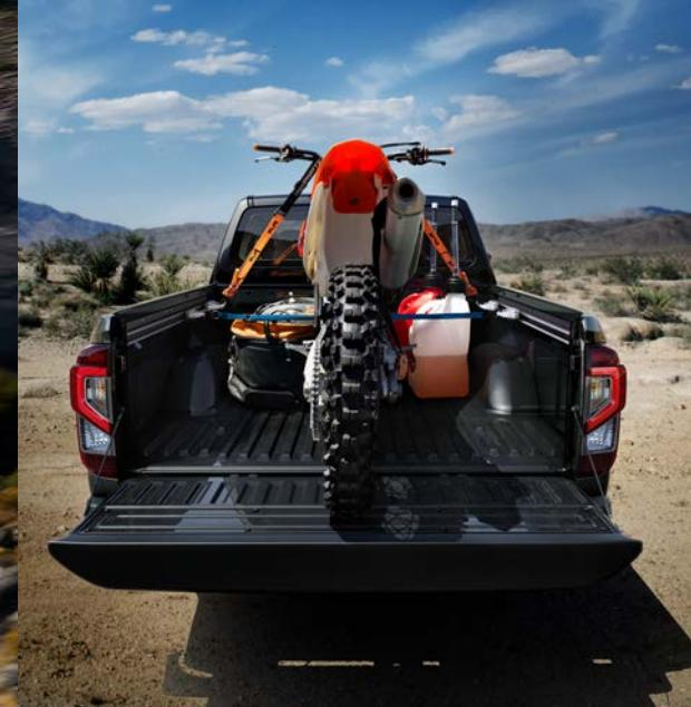
El Sistema Utility-Track es ideal para asegurar hasta la carga más pesada. El sistema consta de dos canales a lo largo de la caja de la Pick-Up y cuatro resistentes ganchos de carga que te permiten colocar puntos de amarre estables prácticamente en cualquier lugar.
