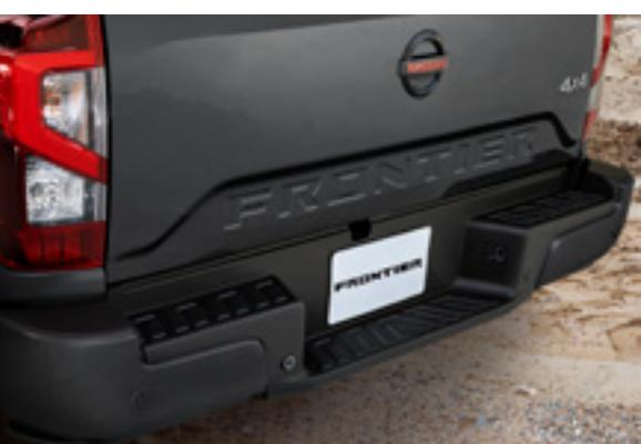
El nuevo escalón integrado en el parachoques, te permitirá acceder de forma más fácil al área de carga.
