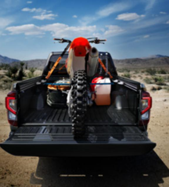
El Sistema Utility-Track es ideal para asegurar hasta la carga más pesada. El sistema consta de dos canales a lo largo de la caja de la pickup y cuatro resistentes ganchos de carga que te permiten colocar puntos de amarre estables prácticamente en cualquier lugar.
